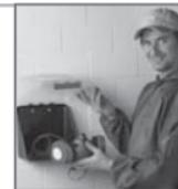
Masker som er i bruk skal oppbevares i dertil egnede hygienebokser, i spesielle lagerskap eller andre egnede beholdere, for å beskytte dem mot støv og damp. Maskene skal være tørre når de lagres. De skal ikke utsettes for direkte sollys, og ikke oppbevares nær varmekilder. Lagg aldri maskene i løsemidler.
