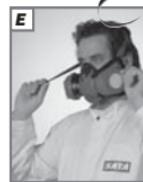
**3.5 Dichtprüfungen vor dem Gebrauch (wahlweise)****F****Unterdruckprüfung**
