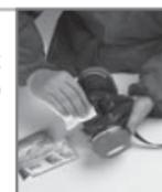
Для правильной дезинфекции нужно использовать очиститель, предназначенный для очистки полумасок, **номер заказа 134965**.
